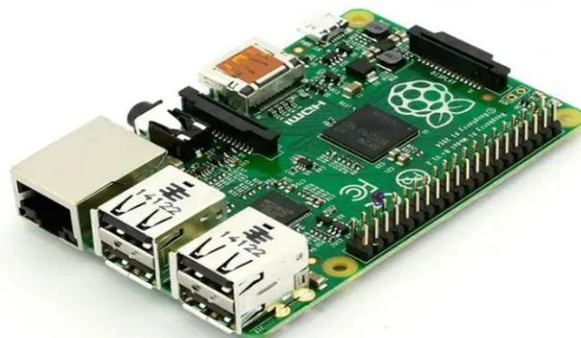
Fig 3: Raspberypi B+ module
